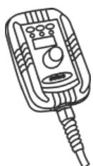
Il dispositivo RC 100 è un comando a distanza per la visualizzazione e la regolazione della corrente e della tensione di saldatura.
