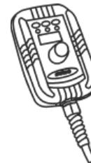
Η διάταξη RC 100 είναι ένα τηλεχειριστήριο για την εμφάνιση και τη ρύθμιση του ρεύματος και της τάσης συγκόλλησης.
