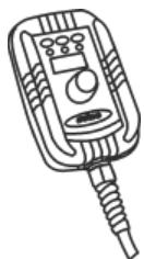
Le dispositif RC100 est une commande à distance permettant l'affichage et le réglage du courant et de la tension de soudage.
