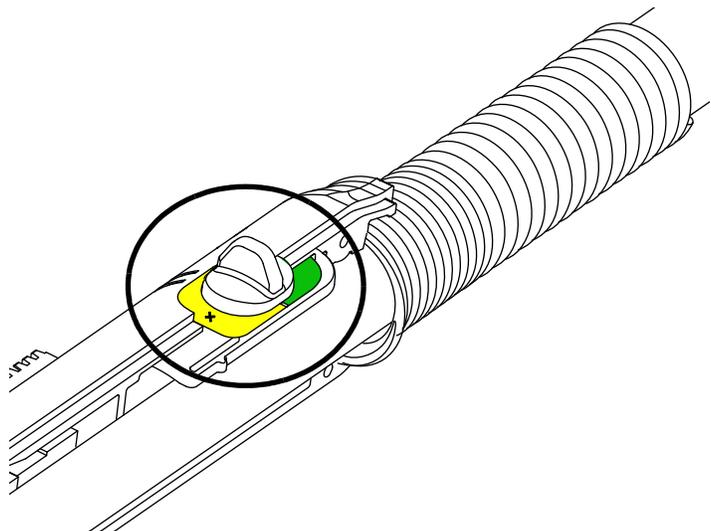
9. Fixer l'enveloppe gauche de la torche à l'enveloppe droite à l'aide des 7 vis. Tenir fermement les enveloppes de la torche au niveau de la base à côté du serre-câble et les maintenir ensemble pendant la mise en place des vis.
