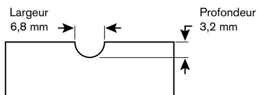
Les tableaux suivants présentent le profil de gougeage 45 A à 40° et à 50° sur l'acier doux et l'acier inoxydable. Ces réglages sont destinés à servir de point de départ pour aider à déterminer le meilleur profil de gougeage pour une tâche de coupe précise. Ajuster ces réglages en fonction de l'application et des données du tableau pour obtenir le résultat souhaité.
