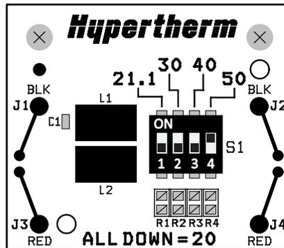
4. Régler les commutateurs DIP à l'une des positions suivantes puis remettre le couvercle de la source de courant en place.
