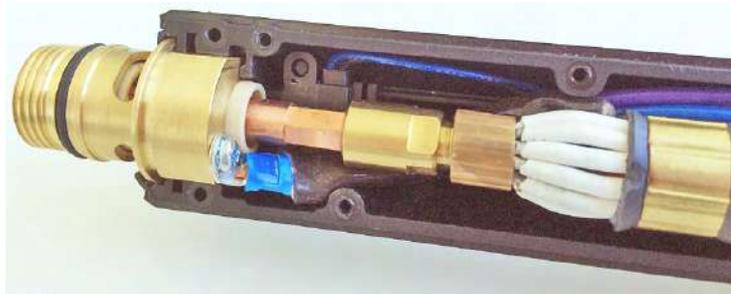
6. Placer le reste du corps de la torche dans l'enveloppe droite de la torche tel qu'illustré. Pendant cette opération, regrouper tous les fils en-dessous du corps de la torche. Ne pas pincer ou sertir les fils. S'assurer qu'aucun des fils ne recouvre les trous de vis de l'enveloppe de la torche.
