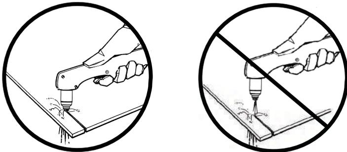
Si vous utilisez le système sur un réseau électrique de moindre puissance nominale, l'expansion de l'arc plasma pendant de longues périodes peut entraîner une surchauffe plus rapide du système et un déclenchement du disjoncteur. Consulter *Réduction du courant de sortie et de l'allongement de l'arc pour un réseau électrique de puissance nominale moindre* à la page 32.
