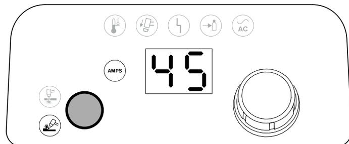
2. Appuyer sur le bouton **Mode** et le maintenir enfoncé d'une main. Tourner le bouton de réglage pour régler la pression du gaz au niveau désiré de l'autre main. Dans cet exemple, nous avons baissé la pression du gaz jusqu'à 35 psi.
