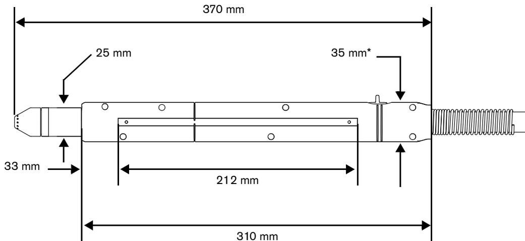
\* Cette mesure correspond à la dimension extérieure de la torche. La hauteur de l'enveloppe extérieure de la torche est de 41 mm, interrupteur de désactivation de la torche inclus.
