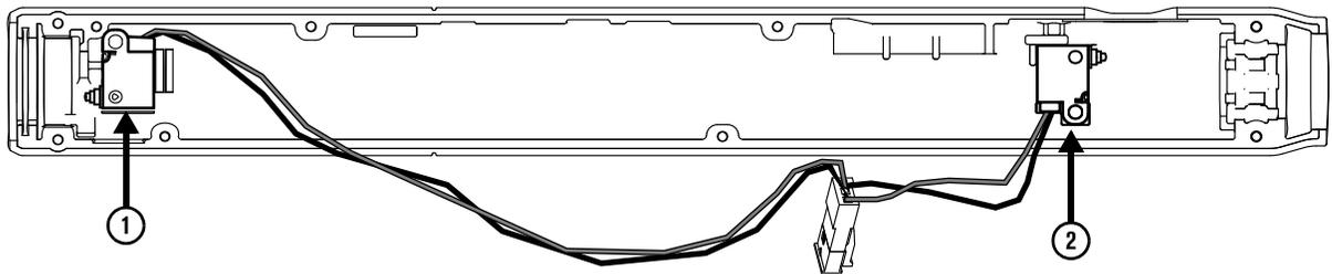
3. Brancher les fils du corps de la torche ③ aux fils de l'ensemble contacteur de détection de buse/interrupteur de désactivation de la torche ④.
