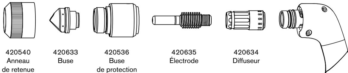
Les consommables FlushCut ont été spécifiquement conçus pour retirer les anneaux de levage, les œillets et les autres éléments sans percer ni endommager la pièce à couper. Les consommables FlushCut produisent un arc plasma incliné permettant une coupe très près du matériau de base, ce qui diminue la quantité de matériel résiduel à meuler.
