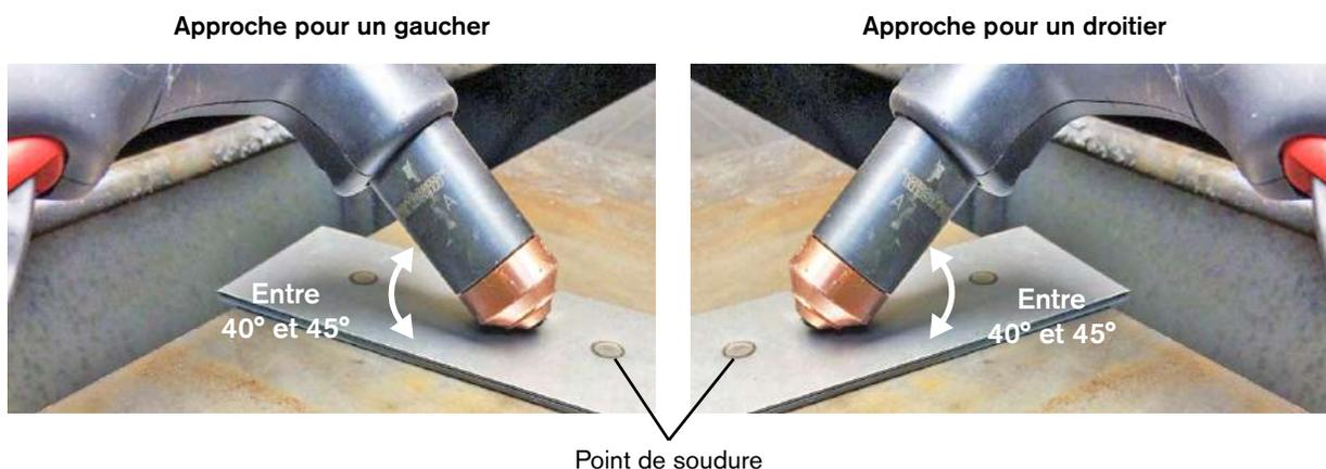
4. Appuyer sur la gâchette pour obtenir un arc pilote. Transférer l'arc sur la pièce, puis procéder à l'expansion de l'arc jusqu'à environ 10 à 11 mm. Maintenir cet arc pendant le gougeage.
