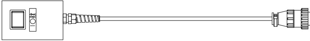
La suspension télécommandée vous permet de mettre en marche ou d'arrêter la torche machine à distance. Par exemple, utilisez-la lorsque vous montez la torche sur un brûleur de crémaillère simple ou sur un guide de coupe qui ne dispose pas de sa propre CNC ou autre contrôleur.
