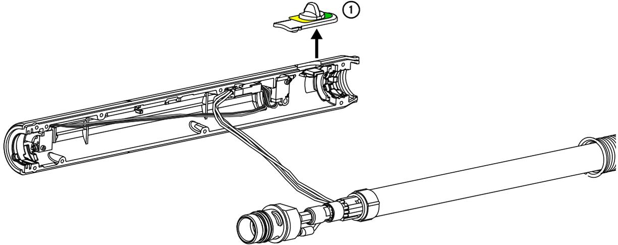
8. Déconnecter les fils qui se trouvent dans l'enveloppe de droite. Appuyer sur la languette du connecteur de fils pour séparer les 2 côtés.
