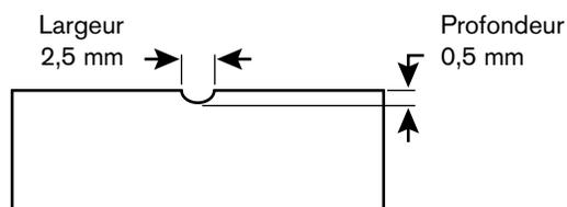
Les tableaux suivants présentent le profil de gougeage 10 A à 40° et à 50° sur l'acier doux. Ces réglages sont destinés à servir de point de départ pour aider à déterminer le meilleur profil de gougeage pour une tâche de coupe précise. Ajuster ces réglages en fonction de l'application et des données du tableau pour obtenir le résultat souhaité.
